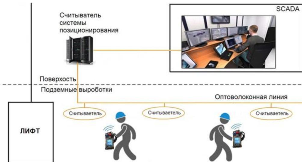
СПУТНИК-1М имеет возможность передачи данных через системы позиционирования СПГТ-41, Flexcom, Davis Derby.
