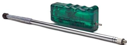
Пробоотборное устройство используется совместно с газоанализаторами Спутник и предназначено для отбора проб воздуха из куполов под кровлей выработки, из колодцев на глубине ( $1,5 \pm 0,2$ ) м и других труднодоступных мест на высоте ( $3,0 \pm 0,2$ ) м от места расположения оператора.
