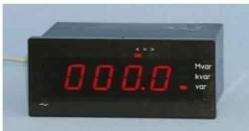
Трехфазные варметры ЦЛ2135 могут быть использованы для измерения и регистрации мощности на предприятиях электроэнергетики.
