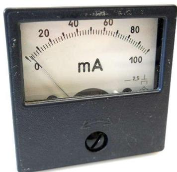
Амперметры, микроамперметры, миллиамперметры, килоамперметры ЭА2231 предназначены для встраивания в измерительную и испытательную аппаратуру, служат для измерения силы постоянного тока в электрических цепях стационарных и переносных устройств, эксплуатируемых в закрытых неотопливаемых помещениях.
