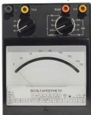
Лабораторный прибор М2051 – прецизионный вольтамперметр постоянного тока применяется при поверке и калибровке менее точных приборов, а также, для проверки параметров изделий при их производстве, контроле и испытаниях.
