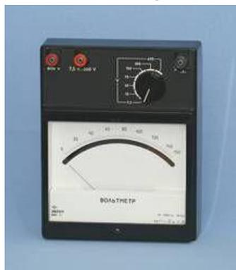
Лабораторные вольтметры ЭВ2265 предназначены для измерения среднего квадратического значения напряжения переменного тока синусоидальной формы промышленной частоты.
