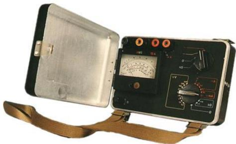
Ампервольтметр ЭК2346 в ударопрочном корпусе может применяться при ремонте, техническом обслуживании аппаратуры и устройств автоматики, в том числе, в полевых условиях эксплуатации.
