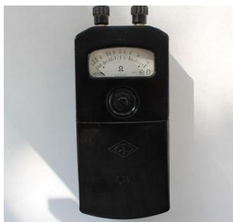
Индикатор сопротивления М57Д предназначен для предварительной оценки величины сопротивления и является вспомогательной частью средств измерений сопротивления электрических цепей оборудования. Он применяется при технических измерениях сопротивления в цеховой практике и на месте монтажа радио- и электроустановок.
